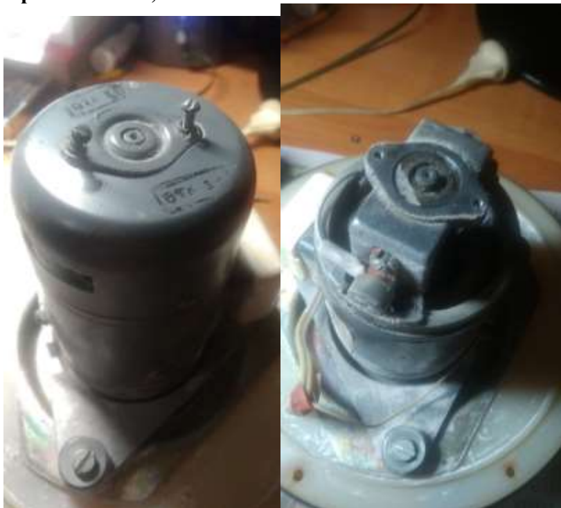
Рисунки 3,4 –Разборка корпуса двигателя
