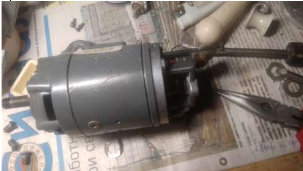
Рисунок 5 – Электродвигатель, отделённый от корпуса.
